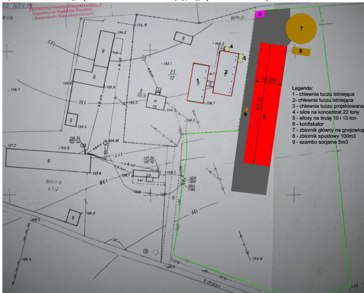
Rys. 5 Planowane zagospodarowanie terenu inwestycyjnego po zrealizowaniu przedsięwzięcia
